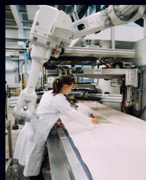
Forschung an der Online-Prepreganlage, mit der am CZM Hochleistungsbauteile aus Faserverbundwerkstoffen hergestellt werden.
